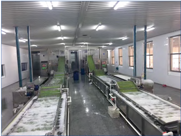
蔬菜速冻生产线结构示意图
